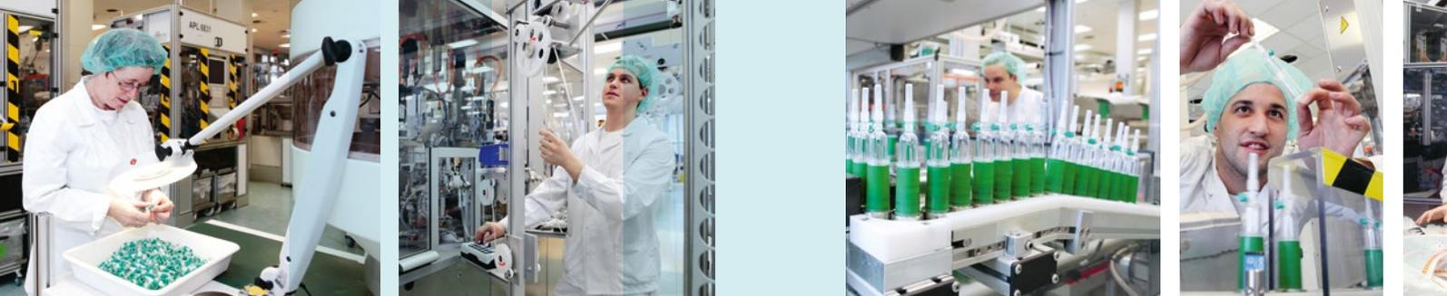
Die Produktion von Medizinprodukten unterliegt höchsten Anforderungen. Alle Hersteller benötigen ein spezielles Qualitätsmanagementsystem. Die Bilder zeigen die Produktion von Infusionsüberleitungsgeräten. (Bilder: B. Braun Melsungen AG)
